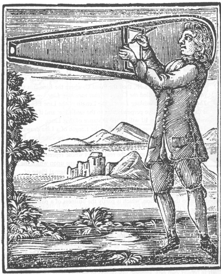
Bild 5. En behändig, transportabel camera obscura för tecknare. Presenterad av Robert Hooke för Royal Society 1694.
